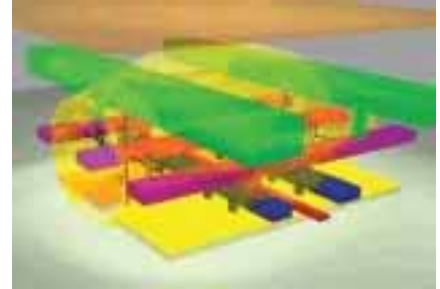
图2: 三维适应性分析参数提取—动态halo计算所有临近和多层互联的电容效应。包括交叉的边缘，角落和容性的阴影
